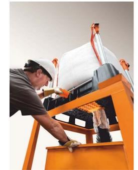
Vidange manuelle avec dosage et d'une installation de verrouillage.
